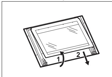
8. Вымойте стеклянную панель водой с мылом. Тщательно вытрите стеклянную панель.
