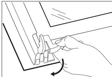
6. Поверніть два фіксатори на 90° і вийміть їх із гнізд.
