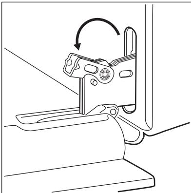
3. Прикройте дверцу наполовину до первого фиксируемого положения. Затем вытяните дверцу вперед из ее гнезда.
